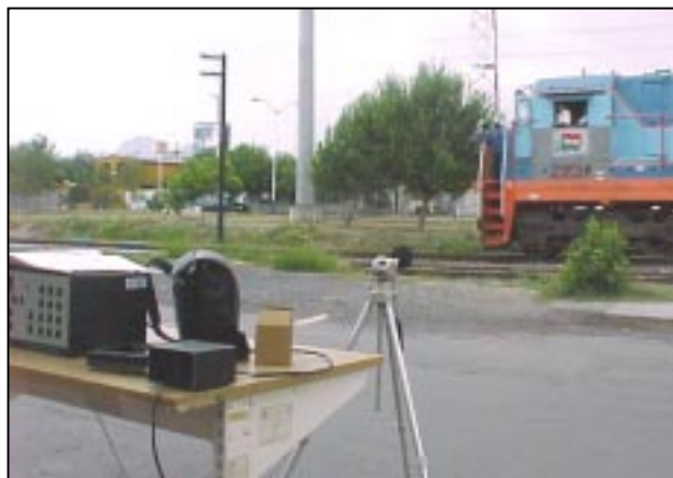
Fig. 2. Equipo de medición utilizado para evaluar los niveles sonoros producidos por los ferrocarriles.
